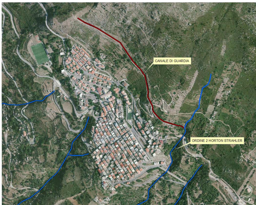
Figura 9: Esempio di canale di guardia che si immette nel reticolo e pertanto da considerarsi a tutti gli effetti come elemento idrico inserito artificialmente nel territorio
