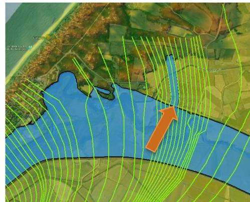
**Figura 4.20 – Insufficienza idraulica dell'argine destro ( $Tr=50$  anni)**
