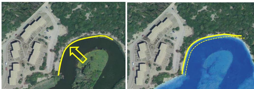
Figura 7.10 – Azioni erosive in atto lungo la sponda esterna del meandro all'inizio del tratto focivo.
