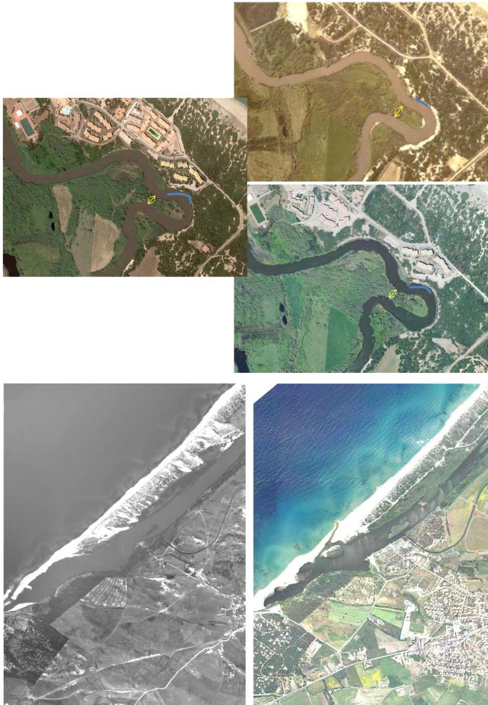
**Figura 7.11 – In alto: ortofoto anni 1977, 2008, 2011. Si osserva il progressivo avvicinamento delle anse con tendenza evolutiva al salto del meandro. Un evento di piena intenso potrebbe modificare sostanzialmente la situazione attuale. In basso: assetto della foce del f. Coghinas dalle Ortofoto (anno 1954 e 2008).**
