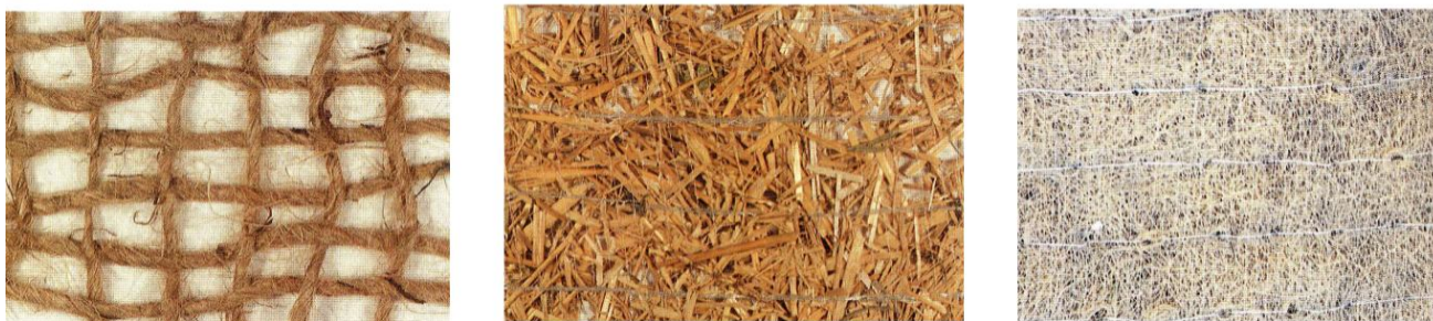
Fig. 14 – Esempi di materiali di rivestimento biodegradabili: a sinistra georete in fibra di juta, al centro biostuoia in paglia ricoperta con materiale plastico fotodegradabile, a destra biostuoia in fibra di cocco ricoperta con materiale plastico fotodegradabile (da REGIONE LIGURIA, 1997).
