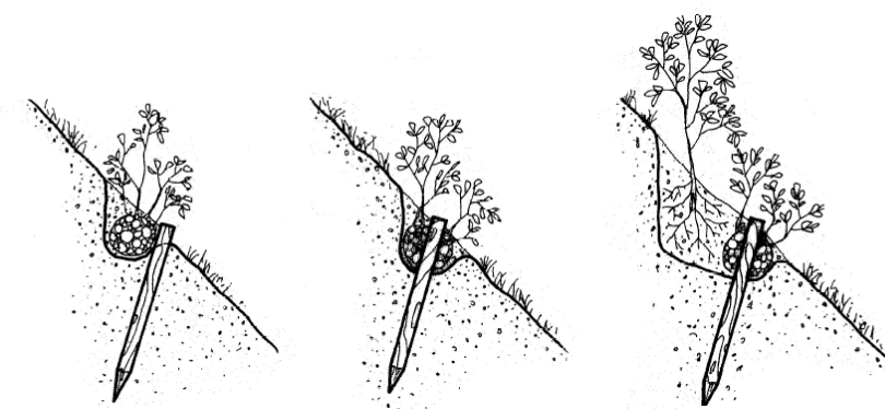
Fig. 22 – Tipologie di fascinate. A sinistra fascinata tipo Hofmann, al centro tipo Kraebel, a destra fascinata con piantina (Provincia Terni, 2003).
