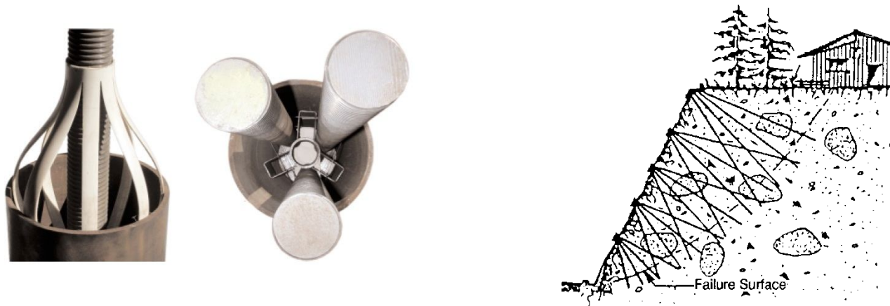
Fig. 94 – A sinistra, esempi di armature di micropali, singole e multiple; si notano i distanziatori utilizzati per mantenere le armature in posizione fino alla fine della cementazione. A destra, esempio di stabilizzazione di un corpo di frana tramite reticolo di micropali (da LIZZI, 1977).
