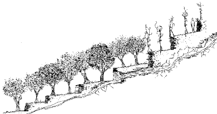
Fig. 56 – Esempio schematico di utilizzo di muretti a secco nella stabilizzazione della coltre detritica di un versante tramite gradonatura (da BRANCUCCI et al., 2000).
